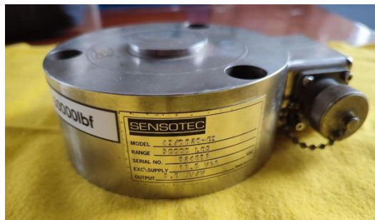
Foto N° 1 Celda de carga SENSOTEC 50KLb
